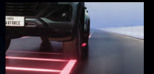
ใหม่! LDP (Lane Departure Prevention) ระบบช่วยควบคุมรถไม่ให้ออกนอกเลน พร้อม LDW (Lane Departure Warning) ระบบช่วยแจ้งเตือนเมื่อรถออกนอกเลน
